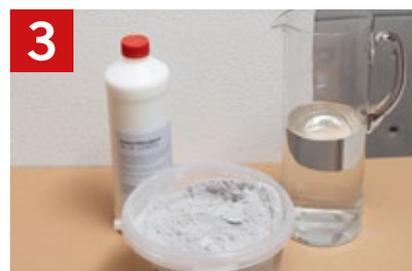
**3** Mit dem Rührwerksmischer in sauberes Leitungswasser (ca. 0,9–1,3 l je nach Nuance auf 1 kg Trockenmasse) bzw. bei gegebener Kennzeichnung mit ORTNER Anmachflüssigkeit einrühren.
